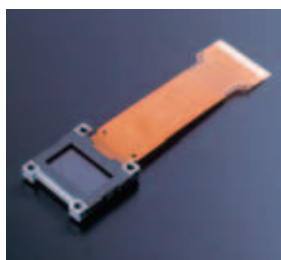
液晶パネル ・対角サイズ:2.3cm (0.9インチ) ・画素数:1920画素×1080画素 ・RGB各1枚のパネルを搭載
