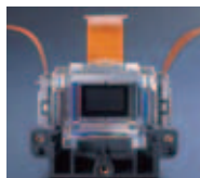
液晶パネル ・対角サイズ:2.3cm (0.9インチ) ・画素数:1920画素×1080画素 ・RGB各1枚のパネルを搭載
