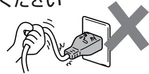
コードを引っばると、コードが破損し、感電・ショート・火災の原因となることがあります。
