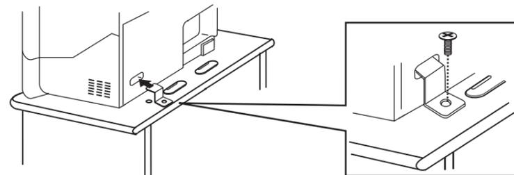
テレビ固定金具をテレビの背面の手かけ部分に差し込み、天板の穴位置と金具の穴位置を合わせます。金具取付ねじでテレビ固定金具をとめます。
