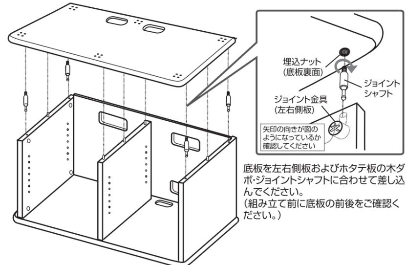
底板を左右側板およびホタテ板の木ダボ・ジョイントシャフトに合わせて差し込んでください。(組み立て前に底板の前後をご確認ください。)
