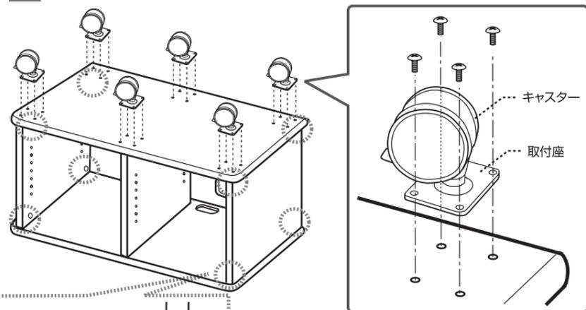
プラスドライバーを使って、キャスターを上図のようにキャスター取付ねじ4本で固定し、6箇所取り付けてください。取付座のねじ穴の形状は異なりますが、どの向きで固定していただいても支障ありません。
